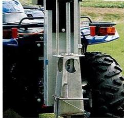
Der neue, konische Behälter ermöglicht eine noch bequemere Entnahme des Probematerials.
