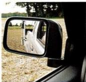
Durch seitlichen Anbau wird die Überwachung der Probenahme im Seitenspiegel des Trägerfahrzeugs möglich!
